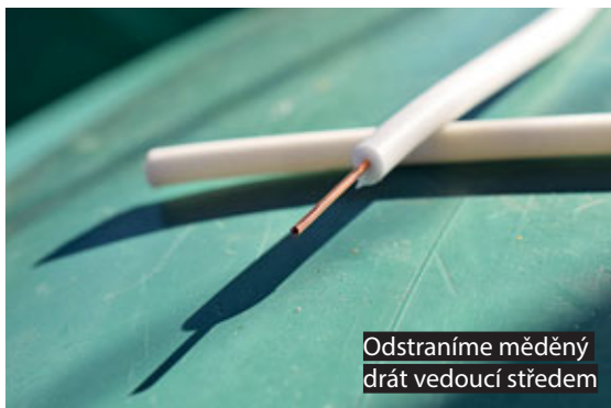
Kabel zbavíme vnějšího pláště a stínění
